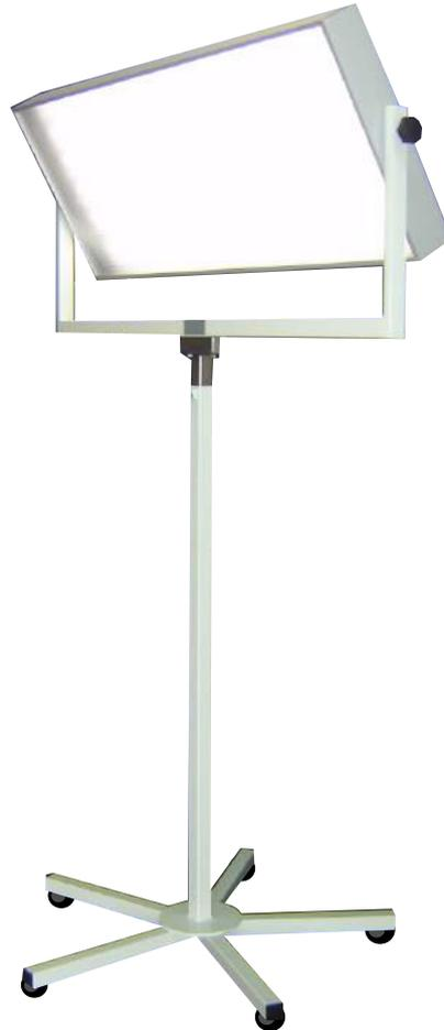
Lámpara de iluminación está fabricada con un bastidor de aluminio anodizado de 1300 x 500 x 100 mm. con 6 tubos TL- 5 de 55 W. - 54 W.  $\varnothing$  16 encendido electrónico regulable 3.800 lux - 6.800 K. en un lado de la pantalla está montado el interruptor de encendido y el regulador electrónico de intensidad lumínica.
